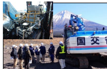
国交省保有の遠隔施工機械を活用した操作訓練
