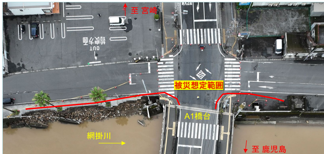
◆写真②(A1橋台下流側護岸損傷)
